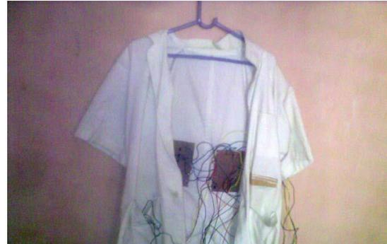
圖 5 透過 Arduino 開發穿戴式裝置 [3]
