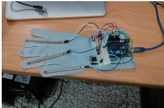
圖 8 手部 Arduino 裝置實作結果
