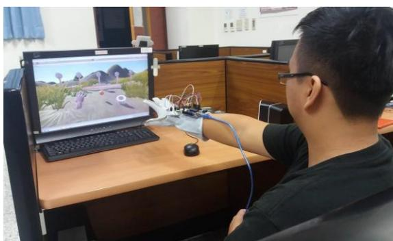
圖 12 整合 Arduino 手部互動裝置後之 3D 丟擲遊戲系統實作結果
