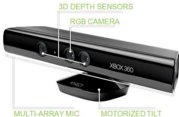
圖 2 Kinect 感測器
