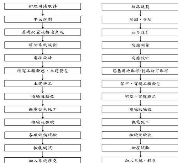
圖 1、變電所興建流程 圖 2、輸電線路興建流程
