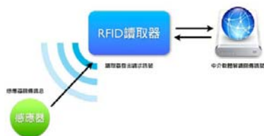
圖 2. RFID 動作原理示意圖
