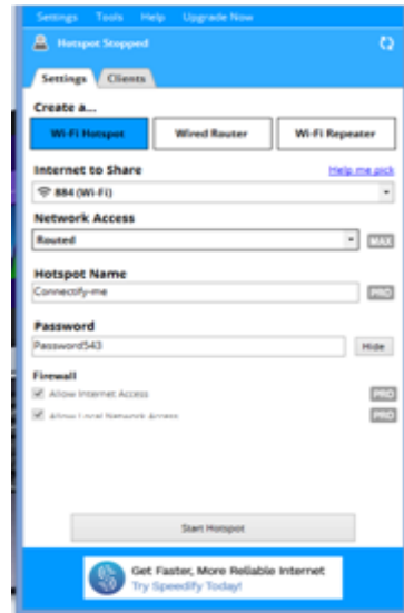
圖 4 筆電安裝 Connectify Hotspot 軟體，使筆電成為無線基地台
