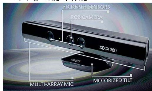
圖1 Kinect外觀構造圖 [5]
