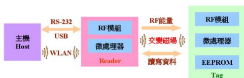
圖 1.3.1 RFID 動作原理
