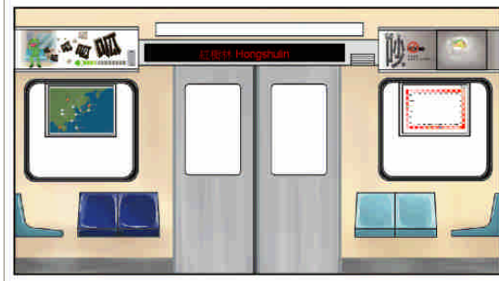
圖 9 台北捷運車箱內多媒體銀幕位置示意圖 註：左方之銀幕(即時資訊)、右方之銀幕(行車資訊)。中間跑馬燈銀幕(現行設計)的到站變換速度與右方之銀幕到站變換速度一致。
